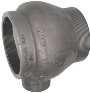
PROKOSCH Ringdüsen sind geeignet für pneumatische Förderung, zum Beschleunigen der Förderung von pulverisierten und granulierten Gütern. Einbau mittels Gewinde direkt in die Förderleitung bzw. wahlweise mittels Flansche oder einer Kombination von Flansch und Gewindeanschluss. Einbringung der Förderluft mittels eines nach oben, bzw. dem Medium entgegengerichteten Anschlussstutzen.
